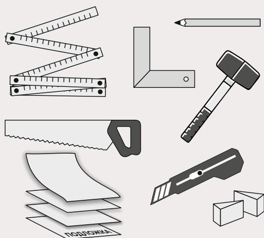
**6.1** Для укладки SPC-покрытия высокой плотности (кварцевого ламината FARGO) потребуются линейка, карандаш, пила (или электролобзик), угольник, распорные клинья, нож, резиновая киянка, плотная подложка толщиной 1,5 мм.
