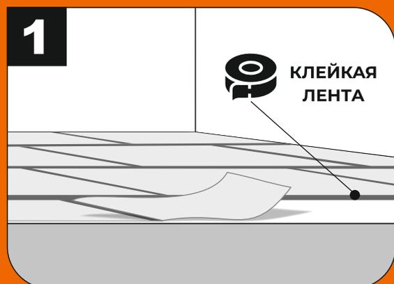
**7.1** Для обеспечения комфорта при эксплуатации расстилается плотная подложка толщиной 1,5 мм. Подложка укладывается встык и закрепляется при помощи клейкой ленты по всей длине стыка.
