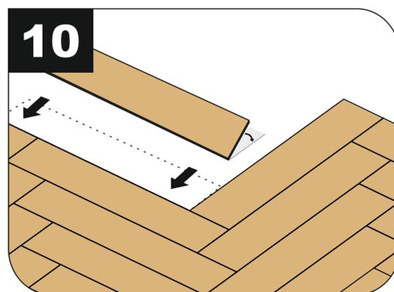
**7.6.2** Установите А-образные плашки, как показано на рисунке. Тщательно проверьте стык между плашкой А и треугольником. Не должно быть никаких выступающих краёв и зазоров!
